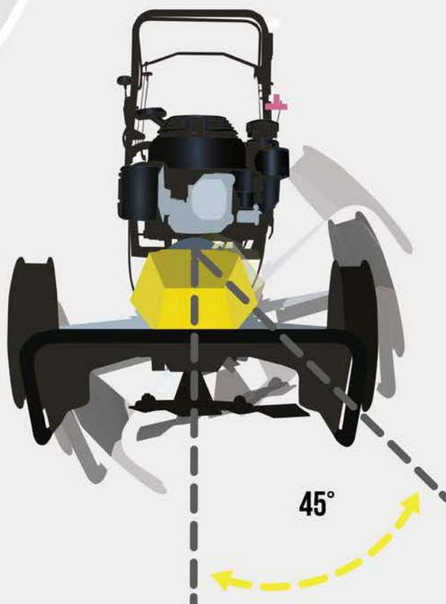
El sistema de motor oscilante patentado permite trabajar hasta pendientes del 100% (45°) con motores de cuatro tiempos.
